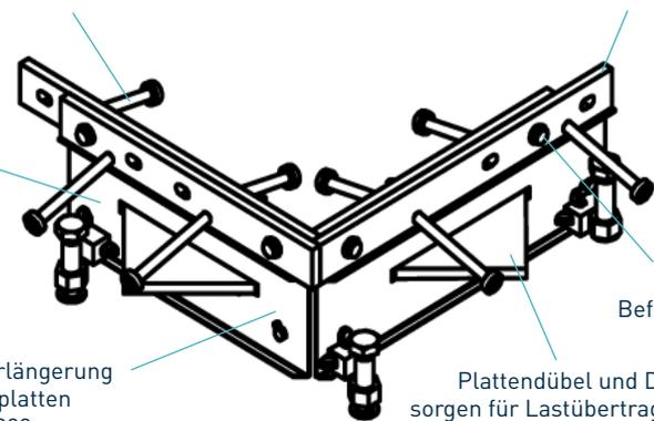
\*\*Universalverlängerung für Bodenplatten 150mm – 200mm
