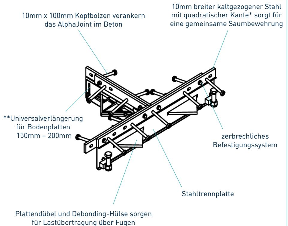
\*Auch in elektro-galvanisiertem und rostfreiem Stahl erhältlich
