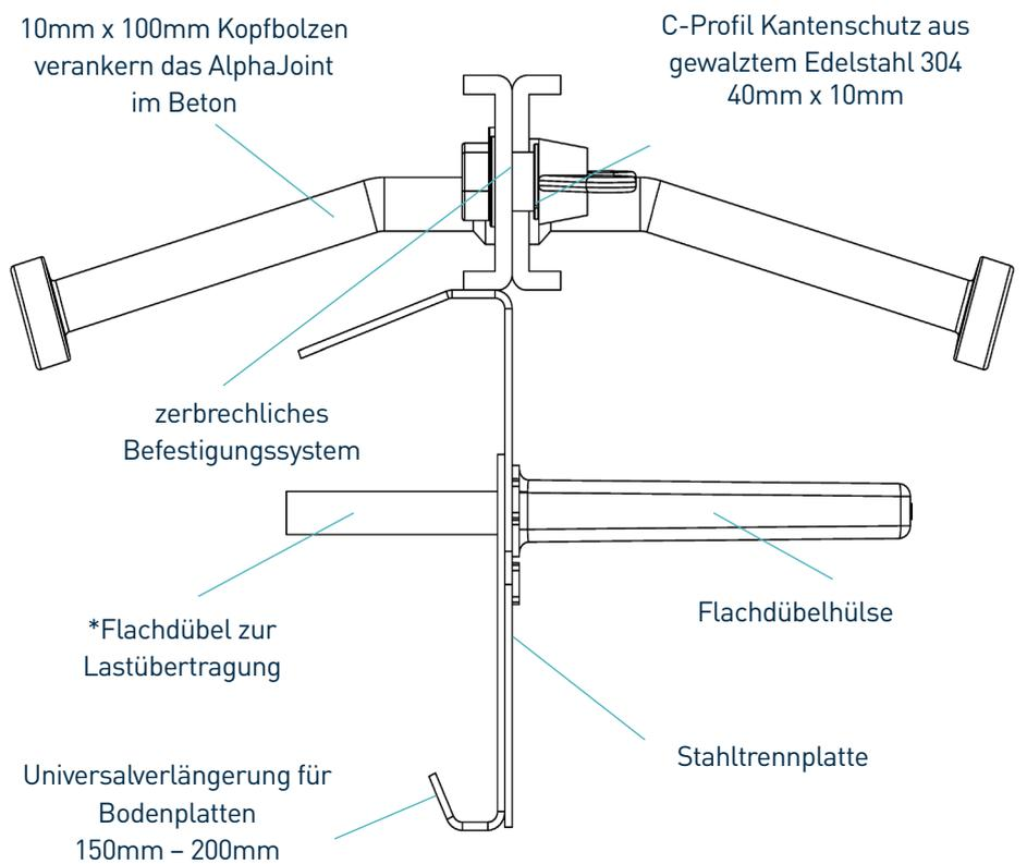
\*Die Flachdübel sind in einer Dicke von 6mm, 8mm und 10mm
