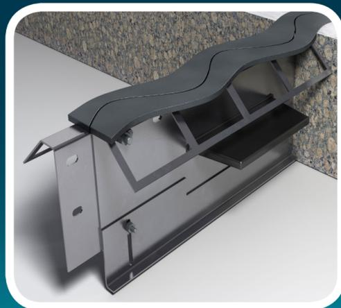
Permaban Wave est un joint polyvalent, sans impact et facile à installer. Sa conception à triple courbe ne comporte pas de bords droits, ce qui permet aux équipements de manutentions de se croiser facilement dans toutes les directions. La plaque supérieure étroite favorise la stabilité et le nivellement. Une plaque d'extension permet aux installateurs de choisir la hauteur de joint correcte, puis d'utiliser le surplus de stock sur le chantier suivant.
