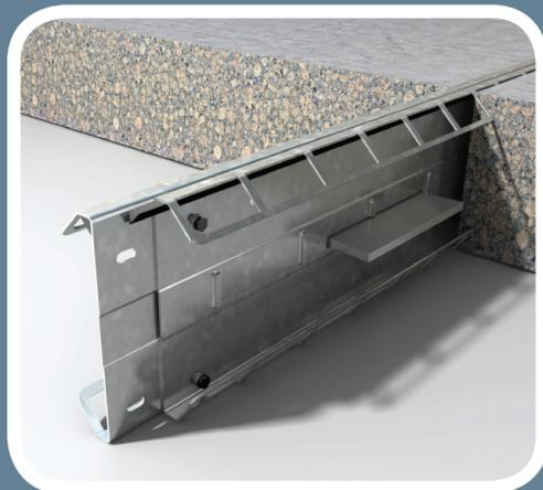
Eclipse est un joint blindé robuste et résistant pour les applications difficiles. Une section triangulaire en acier à haute résistance renforce le bord supérieur du joint, de sorte qu'il puisse résister à un trafic intense et persistant. La tôle de séparation pleine hauteur ajoute à sa résistance et à sa rigidité, faisant d'Eclipse une alternative polyvalente et économique aux joints de style traditionnel. Galvanisé en standard pour usage interne et externe.
