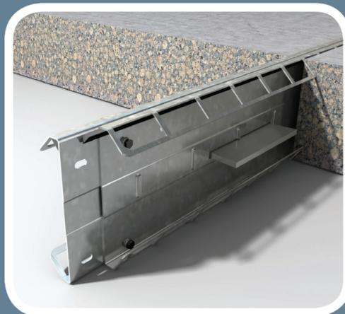
Eclipse es una junta armada sólida y resistente para aplicaciones sometidas a una gran carga de trabajo. Su sección triangular de acero de alta resistencia refuerza el borde superior de la junta para soportar el tráfico intenso y persistente. La placa divisora de altura completa añade más resistencia y rigidez, lo que convierte a la Eclipse en una alternativa versátil y económica a las juntas tradicionales. Galvanizada de serie, para uso en interiores y exteriores.
