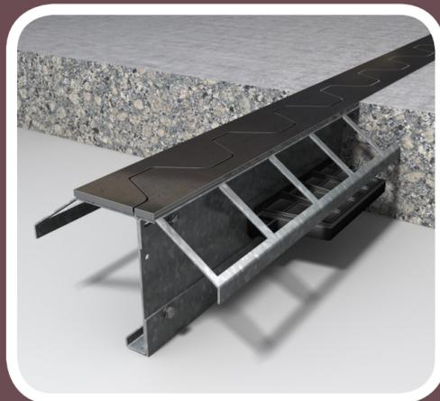
Sin impacto, sin deterioro, ¡sin hueco! La ingeniosa doble placa superior de la SignatureSlide asegura que no quede ningún hueco cuando la junta se abra. Diseñada para cubrir huecos de mayor tamaño, es idónea para soleras sin juntas, soleras postensadas y cámaras frigoríficas y de congelación; también en aquellos lugares donde el hueco sea susceptible de recibir sustancias indeseadas o residuos de cualquier tipo. Sus traviesas continuas garantizan un sólido anclaje.
