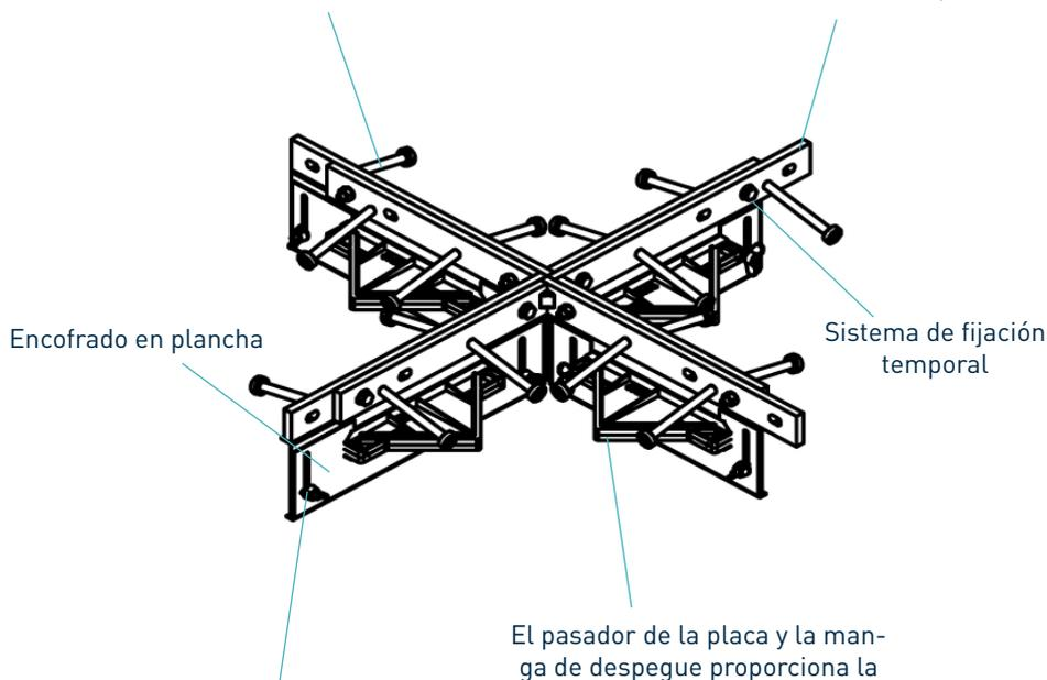
\*\*Extensión universal para espesores de losa 150 - 200
